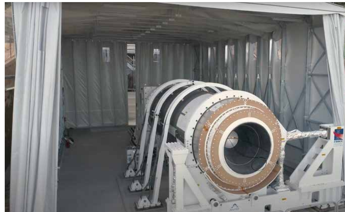
Il motore Zefiro 9 durante un test di prova nel 2020 nel poligono di Quirra: sarà utilizzato per mandare i satelliti in orbita
